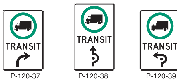
Figure 2 – Panneaux de transit pour carrefours giratoires
